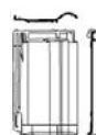
Laumans Tiefsupra Variabel Dækbredde 242 mm Lægteafstand 393-407 mm Længde under nakke 443 mm Vægt 4,0 kg Forbrug pr. m 2 10,2-10,6 stk Antal pr. EUR palle 280 stk
